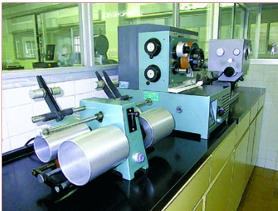
*Aparato de ensayos de impresión.*
