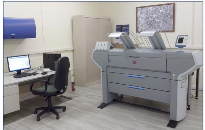
El equipo de impresión adquirido de gran formato dispone de cuatro bandejas para bobinas de hasta 42" y soporta gramajes de papel desde 60 a 160 gr/m<sup>2</sup>, llegando a conseguir velocidades a color de hasta 210 A1/hora.
